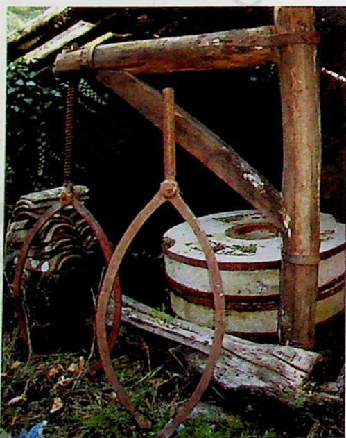
Figura 6.1.f. Par de muelas artificiales procedentes que se han conservado en el molino B procedente de la región de Dordogne (Francia) junto a las dos cabrias de media luna partida. A la derecha se observa un primer plano de las dos muelas con un rodamiento.
