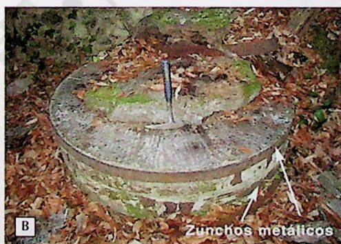
Figura 6.1.j. Dos tipos de muelas que se han conservado en el molino Bajero de Casillas.
