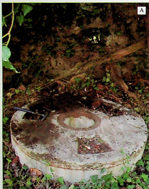
Figura 6.1.d. Par de muelas artificiales que se han conservado en su posición original en el molino A del arroyo Pajarero con detalle de la larija. La otra imagen (B) muestra dos rodeznos.
