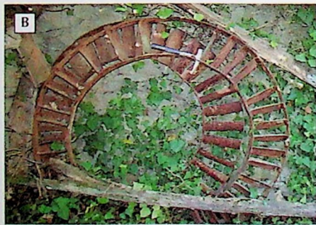
Figura 6.1.d. Par de muelas artificiales que se han conservado en su posición original en el molino A del arroyo Pajarero con detalle de la larija. La otra imagen (B) muestra dos rodeznos.
