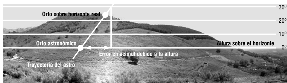
Figura 2.24. Variación del acimut del orto de un astro debido al horizonte real.
