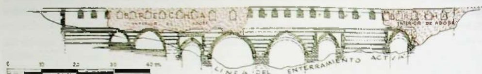
Dibujo 18. Arévalo. Puente de San Pedro, fachada sur, contra corriente. Del siglo XIII-XIV. Bases de pilares, romanas.
