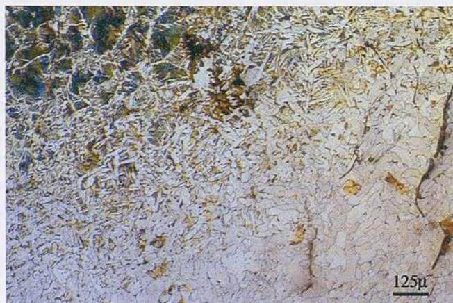
Fig. 2. Microestructura metalográfica de una muestra de lupia de hierro de la ciudad celtibérica de Segeda (Mara, Zaragoza). Hacia el ángulo superior izquierdo, correspondiendo a la superficie del metal, acero al carbono; hacia el ángulo inferior derecho, hierro dulce.
