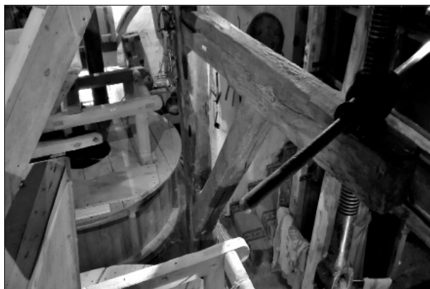
Fig. 22. Vista de la ubicación de las muelas, verdadero lugar en que se realiza la molienda (Foto: Dámaso Barranco).
