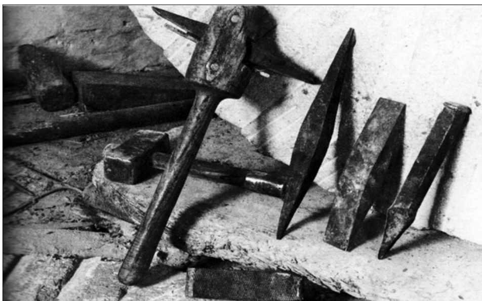
Fig. 31. Herramientas para el picado de las piedras (Foto: Dámaso Barranco).
