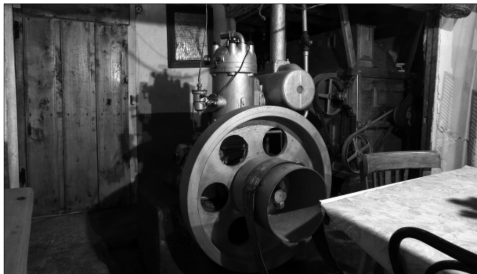
Fig. 13. En primer plano, y tras la mesa que ocupa gran parte del espacio central del molino que hace de distribuidor, un potente y viejo motor de gasóleo que, a mediados del siglo XX, vino a paliar las limitaciones de efectividad del rodezno en los periodos de estiaje del río Corneja (Foto: José Luis Díaz Segovia).
