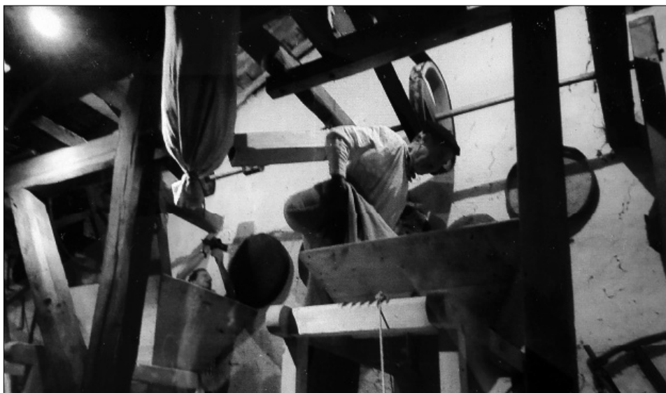
Fig. 26. Molinero echando el grano en la tolva (Foto cedida por Mariano, el molinero).
