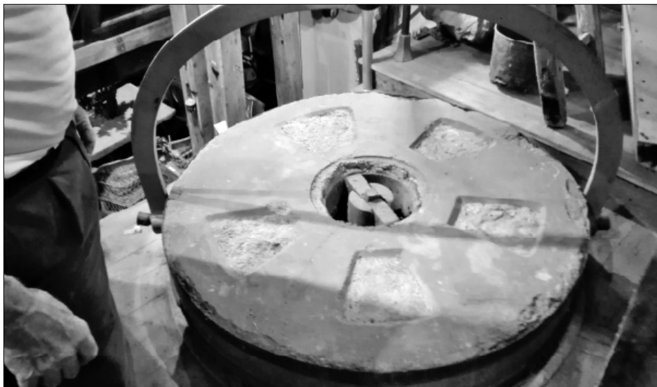
Fig. 30. Cabria preparada con la tijera para levantar y retirar la piedra volandera. Obsérvese los campos o sectores de la piedra con el relleno realizado para su equilibrio (Foto: Dámaso Barranco).
